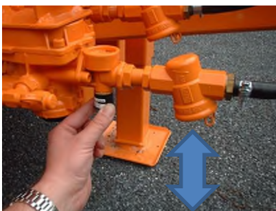
bei manueller Feststellbremse am Ventil ziehen
