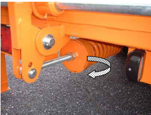
Verstellung der Vorspannung bei Stahlrampen
