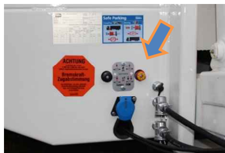
bei automatischer Parkbremse (TEM) roten Knopf drücken
