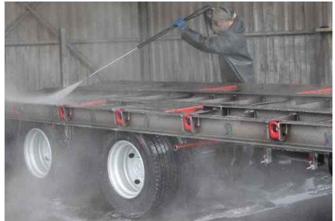
Schritt 2: Vor der Lackierung wird das Fahrzeug von Schweißfetten gereinigt und mit Eisenphosphatierung vorbehandelt - diese unterstützt die Haftung von Lack und verhindert Korrosion
