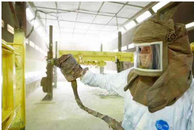
Schritt 3: Grundierung mit Zinkphosphatanteil (verhindert Korrosionsunterwanderungen bei Beschädigung), anschließend Auftragen der ersten Lackschicht im RAL-Farbtönen nach Wahl
