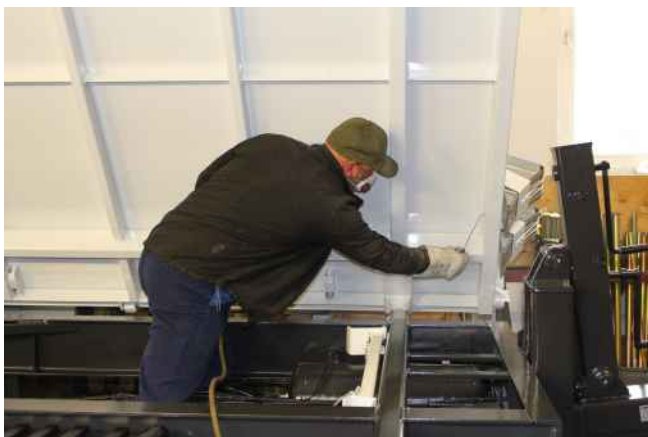
Schritt 5: Hohlraumversiegelung in Fugen und Falzen mit Konservierungswachs
