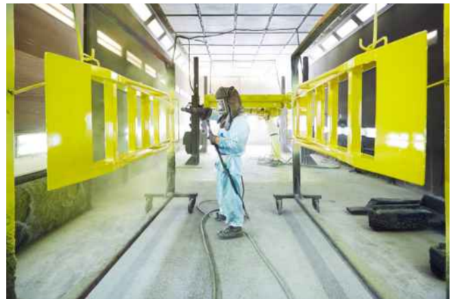
Schritt 4: Auftragen vom umweltverträglichen High Solid 2K Decklack auf Acrylbasis in Erstausrüster-Qualität - der Lack hat eine hohe Deckkraft, ist brillant und beständig
