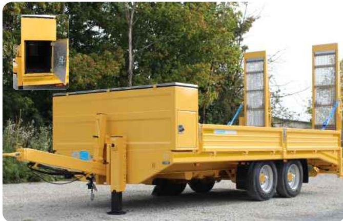
Doppelter Staukasten vor der Ladefläche montiert, unteres Fach durch zwei Türen mit Schließung, oberes Fach mit Alu-Deckel von oben zu beladen; Zwischenboden aus Siebdruckplatte
