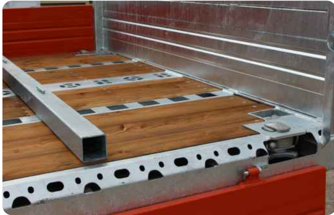
Außenprofil mit doppeltem Lochbild „VarioFrame“ (2000daN Zurrkraft), erweiterbar mit Einschraub-Zurrbügeln (2500daN), TwistLock Container-Verriegelung und Querrohranschlag steckbar
