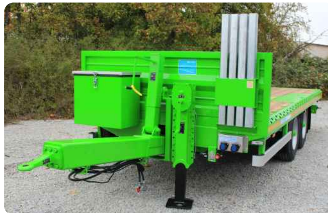
Rungen VarioSave (verschiedene Längen erhältlich) mit Rungenmagazin an Stirnwand, Stahl-Werkzeugkiste aus Eigenfertigung mit Aludeckel
