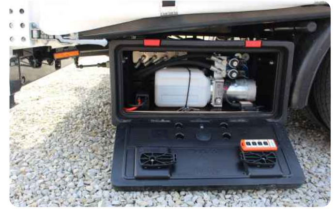
Elektro-Hydraulik-Kompaktaggregat, 24-Volt, mit 2200W Leistung-für die Bedienung der hydraulischen Rampenheber, incl. Funkfernbedienung! Verbaut in einer Kunststoff-Werkzeugkiste auf der Beifahrerseite des Tiefladers, 2-polige NATO-Steckdose an Stirnwand angebracht, Zuleitung zur Pumpe
