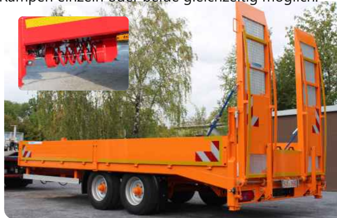
Verbreiterte und verlängerte Rampen mit Federhebewerk zu bedienen, ganz zusammenschiebbar, Alu-Bordwände mittig geteilt, mit Warnmarkierung
