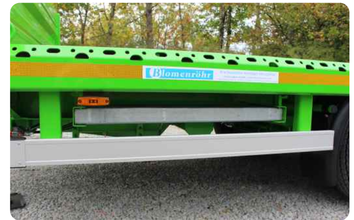
Rungenhalterung unter der Ladefläche mit Sicherung, Außenprofil VarioFrame
