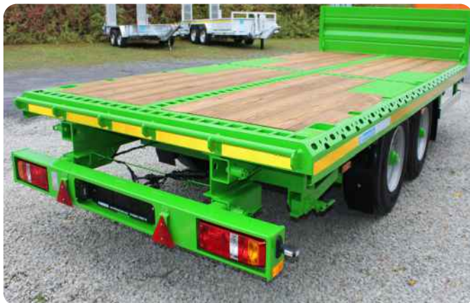
Rungenschienen VarioStake auf der Ladefläche und als Heckabschluß eingearbeitet, Rungensteckvorrichtung seitlich, Außenprofil VarioFrame, Anfahrerschutz ausziehbar
