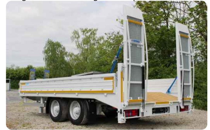
Doppelte Gasdruckdämpfer als Hebeunterstützung
