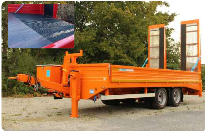
Auf 80cm verbreiterte Rampen mit HEGE-Gummibelag mittig; vorne teleskopierbare Ablage für das Fräsenladeband, HEGE-Belag auch in Auffahrsschräge möglich!
