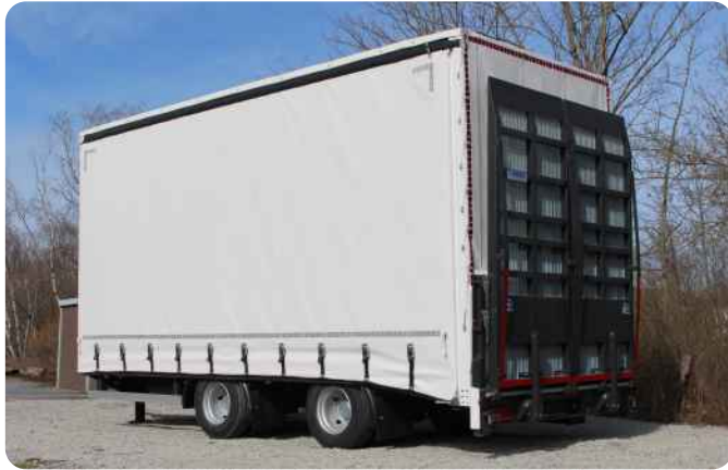
Geschlossene Ladebordwand mit Gitterrosten, mittig einmal geteilt, Planenverdeckgestell mit Schieberverdeck, Innenbeleuchtung und Rollplane hinten
