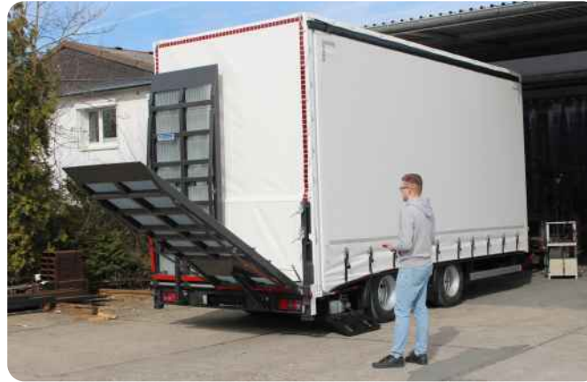
Hydraulische Rampenheber in Kombination mit Elektro-Hydraulik Kompaktaggregat: doppelt wirkende Zylinder mit Rückschlagventil sind unter der Ladefläche geschützt angebracht und mit der Elektro-Hydraulikpumpe verbunden. Die Zylinder werden über die Funkfernsteuerung betätigt. Steuerung der Rampen einzeln oder beide gleichzeitig möglich.
