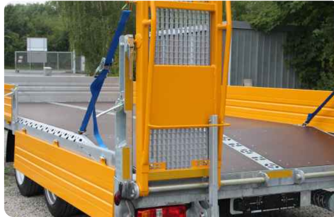
Flexible Ladungssicherung durch mittlere Zurrchiene VarioO für verschiedene Anschlagmittel und Außenprofil mit doppeltem Lochbild „VarioFrame“
